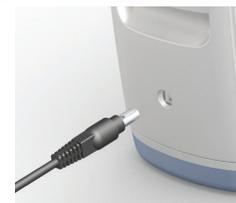
**PRECAUÇÃO** Certifique-se de que a fonte de alimentação universal está num local bem ventilado, dado que ela depende da circulação do ar para dissipar o calor. A fonte de alimentação universal pode aquecer durante o funcionamento. Deixe arrefecer a fonte de alimentação universal antes de a manusear.
